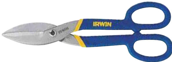
IRW22012 12" Coupe tout droit et grandes courbes. Coupe l'acier laminé à froid de calibre 20 et l'acier inoxydable de calibre 22.
