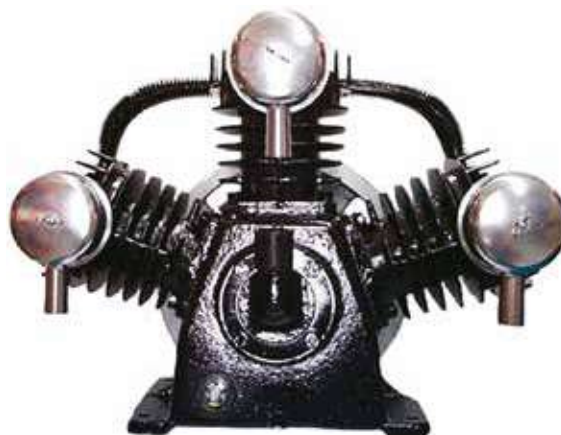
RDPT03A 18.5 CFM @ 100 PSI 5.0 HP Max. : 150 PSI Longueur : 18" Largeur : 12 1/2" Hauteur : 14"
