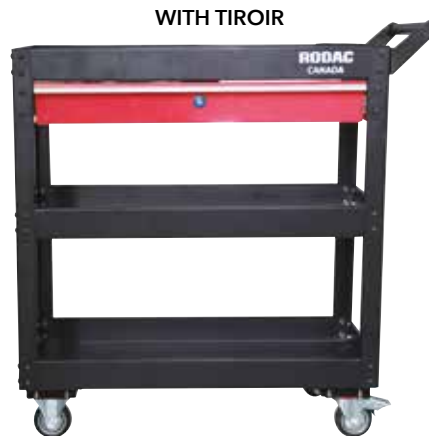
RD09001 27.75" x 13.89" x 26.29" Dimension de plateau : 27.36" x 13.38" x 2.36" Tiroirs avec glissière à roulement à billes Roue de 3", 2 pivotantes et 2 fixes
